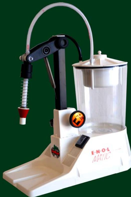
La llenadora "Enomatic" funciona según un principio sencillo, natural y muy eficaz. Quita el aire de la botella, que deberá ser siempre de cristal o un material rígido, produce el vacío en ella y traslada directamente el líquido a su interior, sin pasos intermedios ni contactos con elementos mecánicos. Puede aspirar el producto a un máximo de 4 metros de desnivel y en solo 6 seg. es capaz de llenar una botella de 75 cl.
