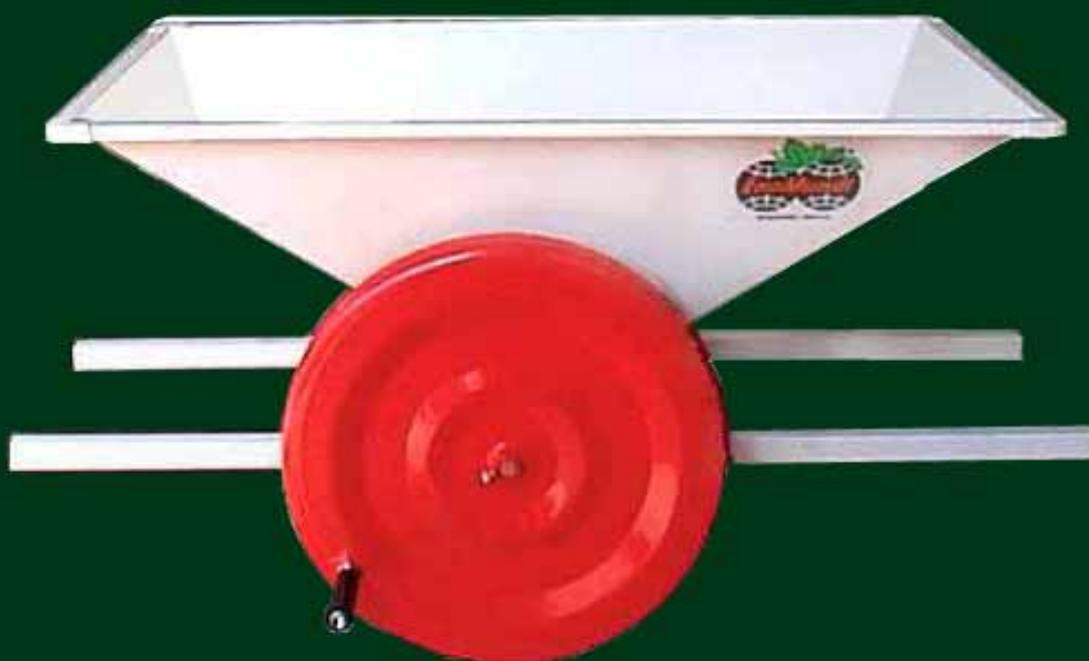
Estrujadora manual con rodillos regulables y agitador. Los soportes utilizados para fijar los rodillos permiten la regulación del grado de estrujado, garantizando asimismo la integridad de los mismos y de los engranajes en la eventualidad de paso de partes solidas.
