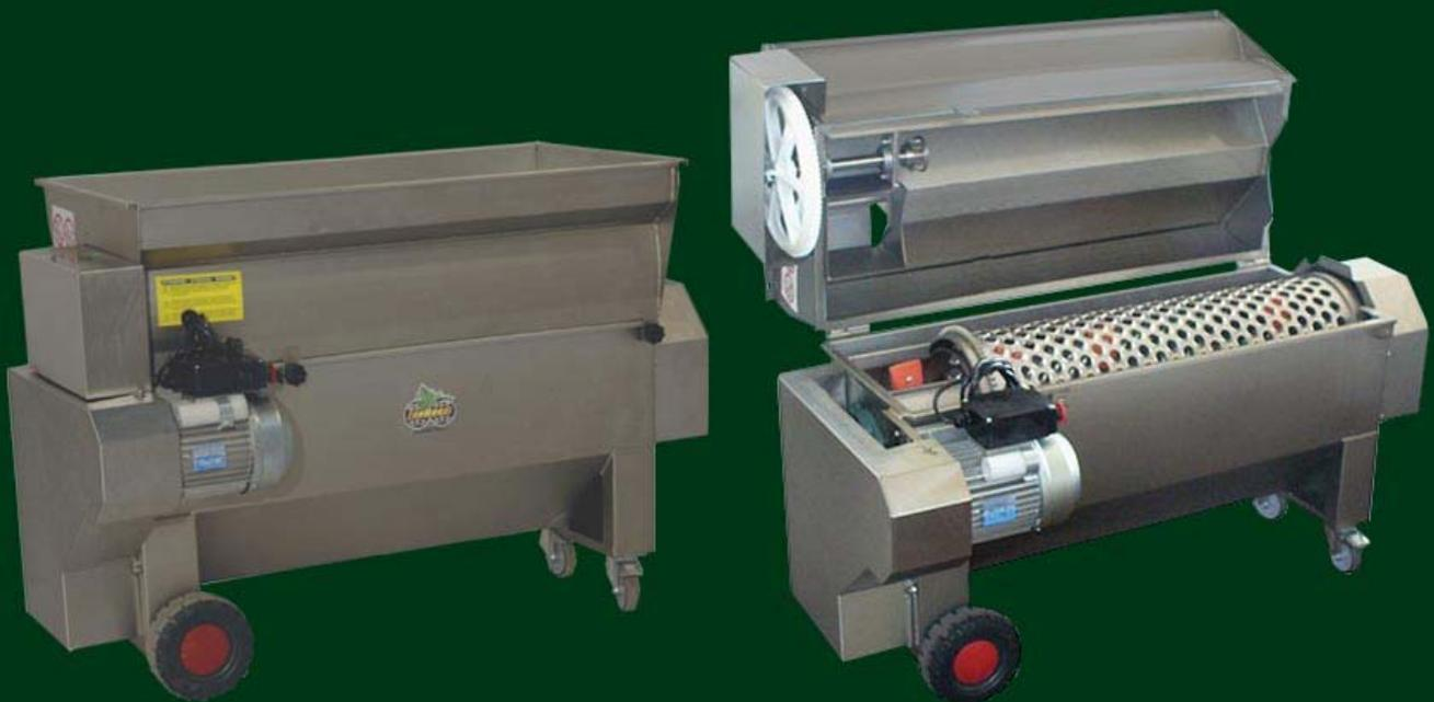
Despalilladora con motor, realizada completamente en acero inoxidable, equipada con tolva de recepción con sinfín de entrada, eje despalillador con paletas forradas en goma, tambor de despalillado giratorio para contrarrestar el golpeo de las paletas y la posible laceración de las uvas y bomba de impulsión de pasta alimentada por sinfín. La máquina se puede abrir totalmente por la parte central para una perfecta limpieza al final de la campaña.
